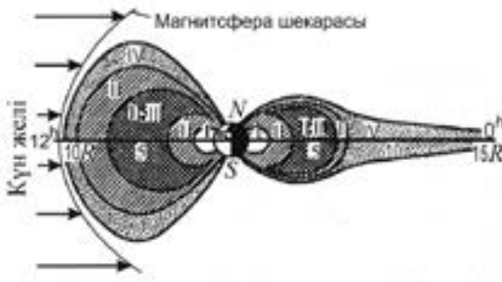
2-сызба. Жердің радиациялық белдеуінің құрылымы: I – ішкі белдеу; II – аз энергиялы протондар белдеуі; III – сыртқы белдеу; IV – квазиқармау аймағы
