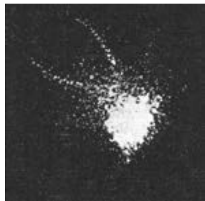
Кавитациялық өрістің жарқырауы (25 кГц жиілікте жұмыс істейтін шағын ферриттік түрлендіргіш түсірген)
