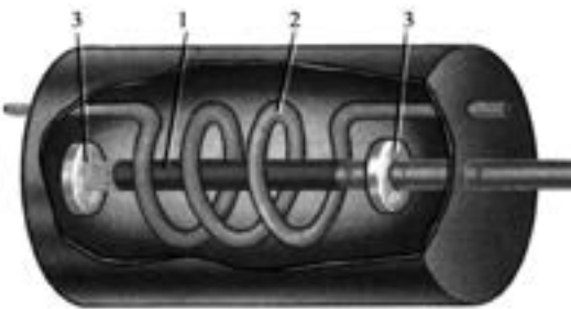
1 – сәуле таратқыш дене; 2 – толтыру шамы; 3 – резонатор айнасы
