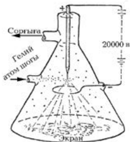
Атомдарды бақылауға арналған Мюллердің иондық микроскопы
