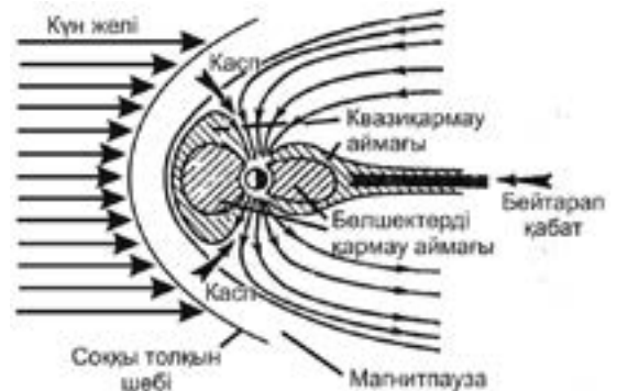
3-сызба. Жер магнитсферасының құрылысы. Жебелі сызықтармен күн желі бөлшектерінің магнитсфераға ену аймағы көрсетілген.
